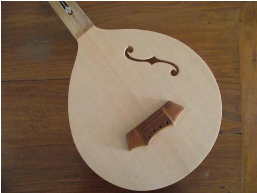
Aspetto do tampo terminado (exterior) já colado ao braço. Ponte em mogno.
