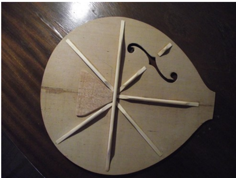
Tampo terminado (interior) com a colagem das barras harmónicas em pinho e reforço da ponte em mogno. Abertura de um elemento decorativo para expansão de som.
