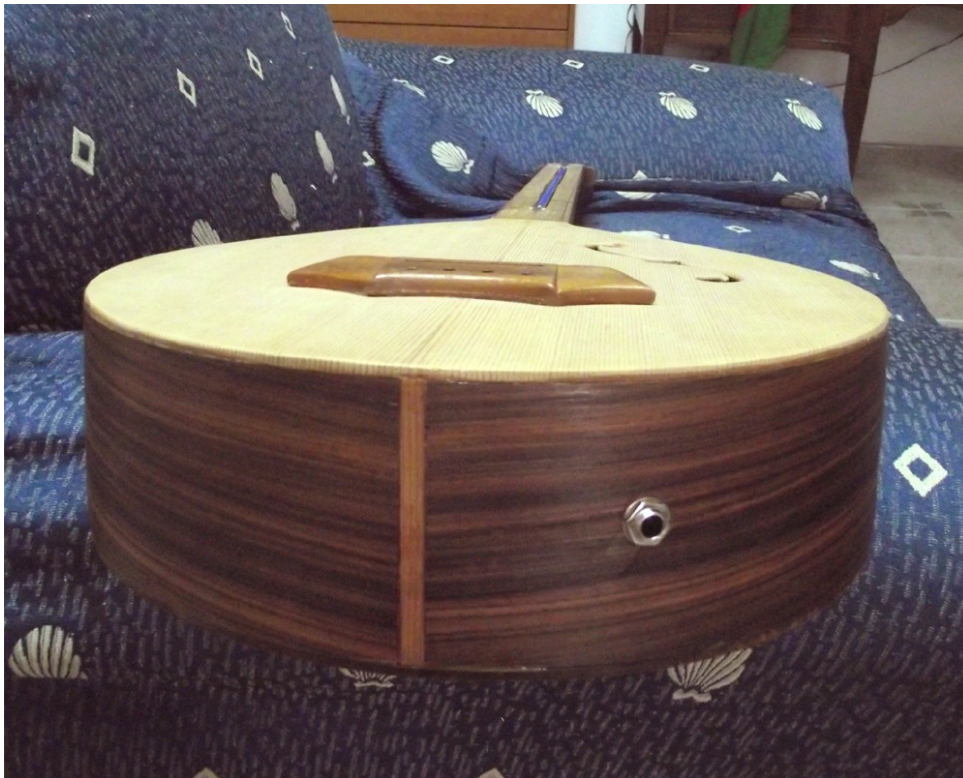
Caixa terminada, faltando polimento e envernizado. Visível o jack fêmea de 6,35mm, ligado ao Piezo elétrico.
